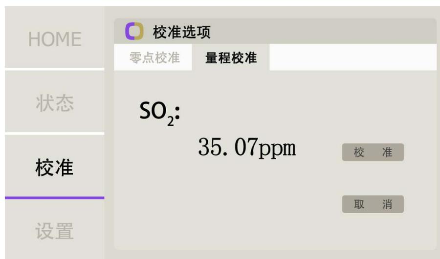
图21 量程校准确定
