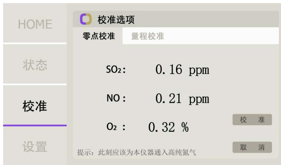
图17 氮气零点校准确定界面
