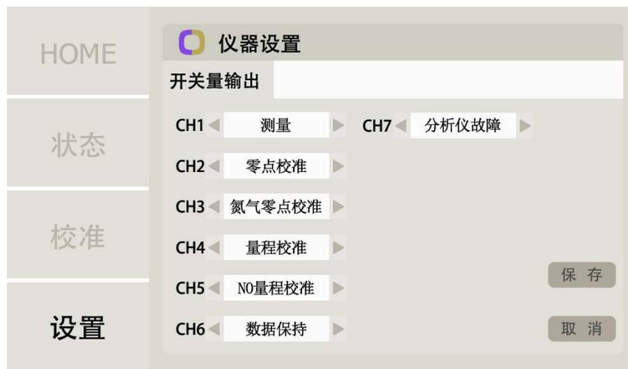
图 28 开关量输出设置
