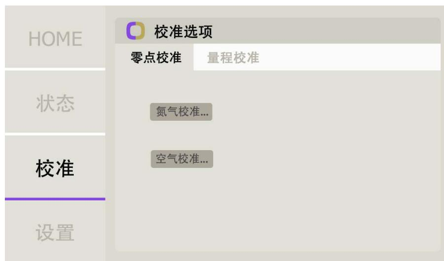
图16 零点校准界面
